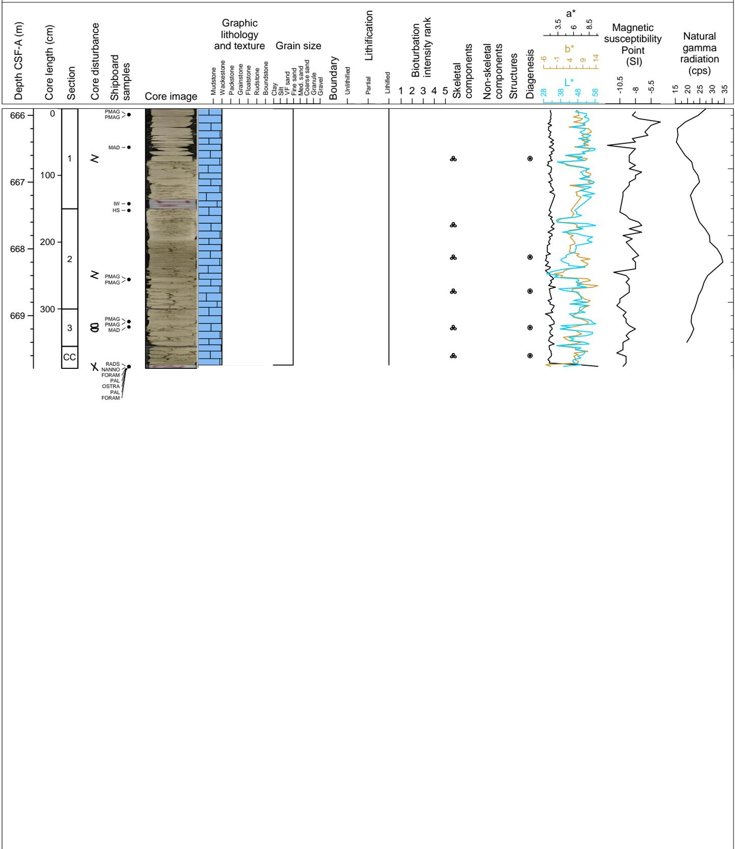
Hole 359-U1467C Core 34X, Interval 675.6-678.69 m (CSF-A)
